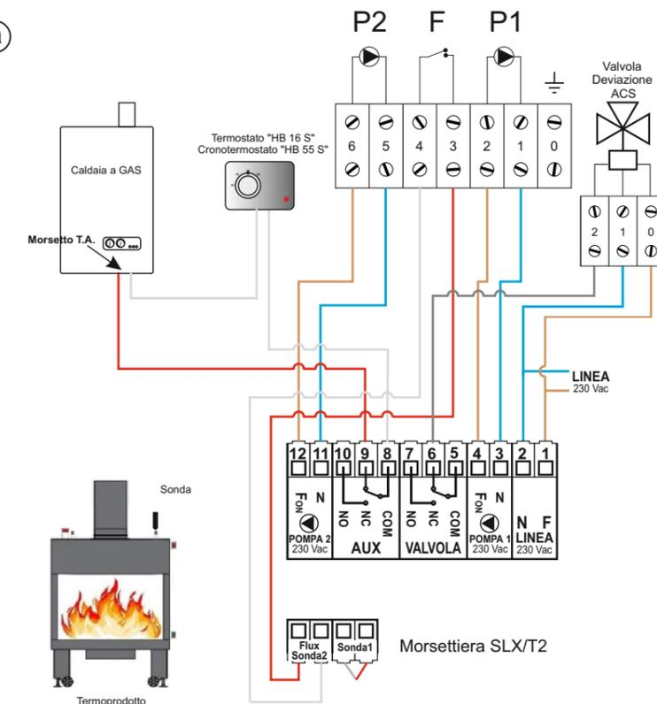
Quando viene installato il modulo mini e cioè quello con un solo circolatore, è necessario utilizzare la pompa nr. 2 della centralina: l'uscita ausiliaria «AUX» e l'adeguato funzionamento del flussostato è legata all'attivazione della pompa nr. 2.
