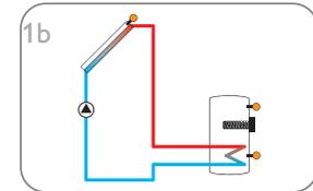
1b Impianto solare standard con 1 serbatoio e riscaldamento integrativo elettrico (p. 8)
