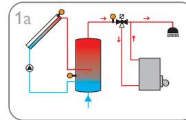
1a Impianto solare standard con 1 serbatoio e riscaldamento integrativo (p. 8)
