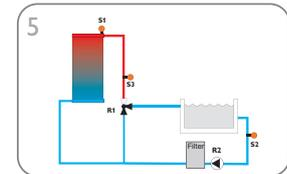
5 Impianto solare per il caricamento di piscine con funzione di filtrazione (p. 13)
