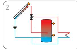
2 Impianto solare con 1 serbatoio e asportazione del calore in eccesso (p. 10)
