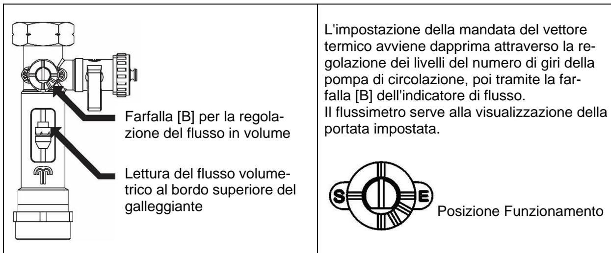
Informazione: Flussimetro viene a mancare per la versione "Sensore di portata volumetrica"
